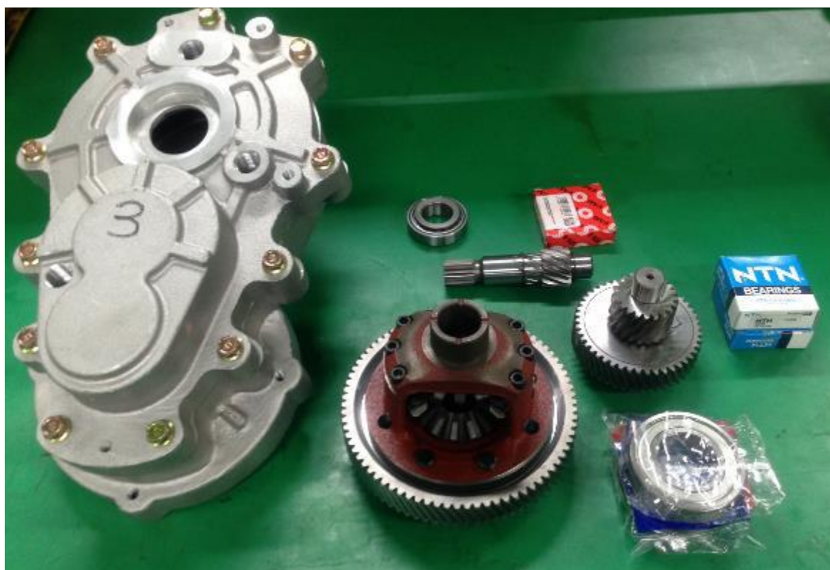
Obrázek 2.3 Fotka komponentů původní kovové verze převodovky [3]
