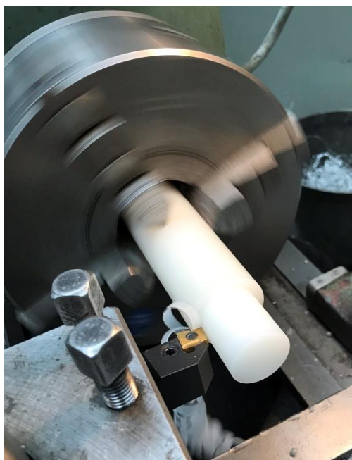
Obrázek 42: Soustružení kontury krycího pouzdra
