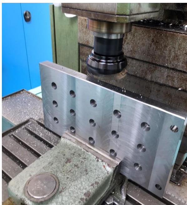
Obrázek 44: Frézování hran upínací desky
