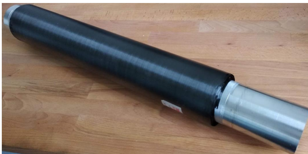
Obr. 43 Ukázka obráběného materiálu PEEK T300
