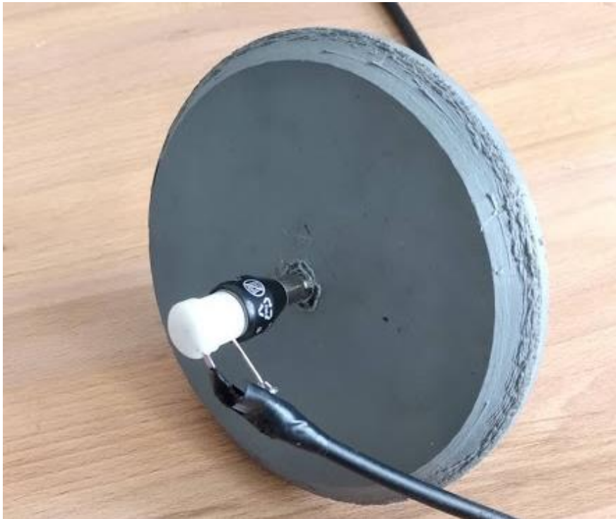
Obr. 41 Ukázka přípravku s rotačním konektorem
