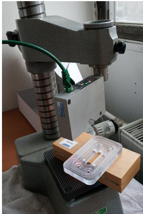
Obr. 34 - Ukázka měření krycího, transparentního plastu
