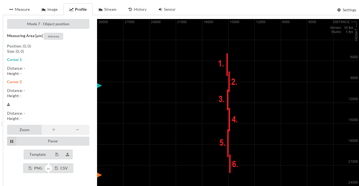
Obr. 32 - Vizualizace jednotlivých měření ve směru height pro délku profilu
