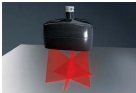
Obr. 2 - Porovnání 2D laseru a hlavou se třemi rovinami osvitu (laserový kříž) [3]
