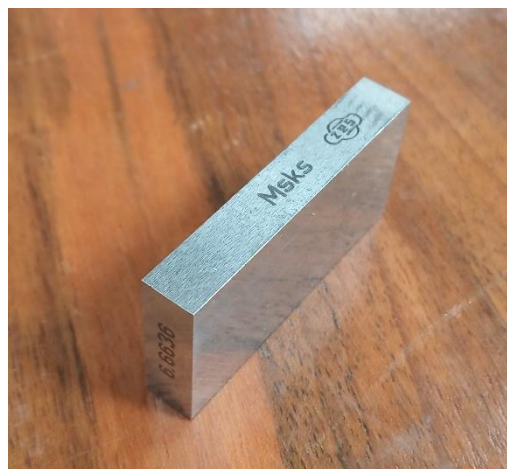
Obr. 35 - Koncová měrka o tloušťce 6,6636 mm
