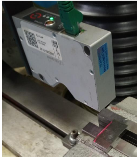
Obr. 72 - Kontrola kolmosti laserového paprsku
