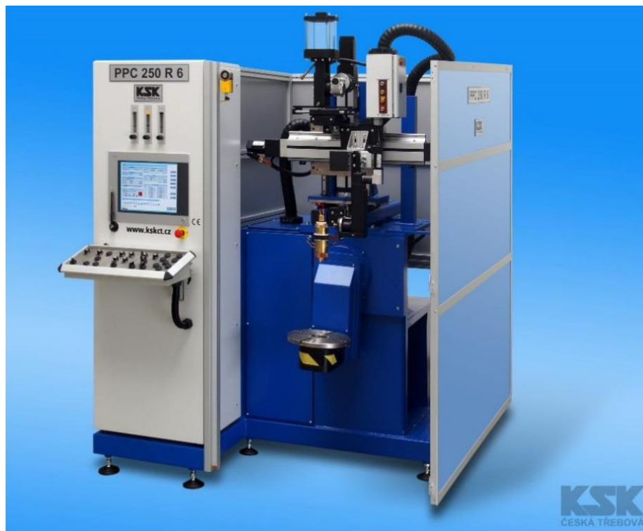
Obrázek 9 - Navařovací automat KSK s.r.o. Česká Třebová [23]
