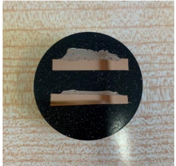
Obrázek 14 - Metalografický vzorek vytvořený pomocí Struers CitoPress - 1
