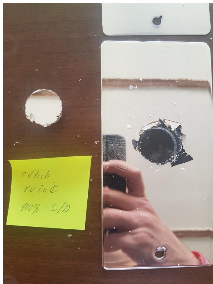
Obrázek 19 – Odtrhová zkouška na vzorku české firmy, odtrženo ručně před měřením (100 % delaminace mezi vrstvami povlaku C/D)
