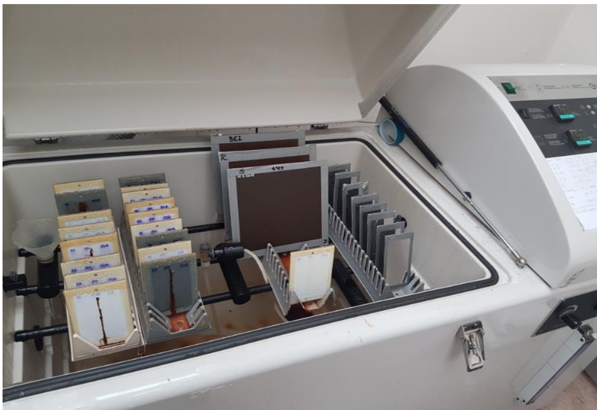
Obrázek 10 – Vnitřek solné komory a umístění zkušebních vzorků do solné komory
