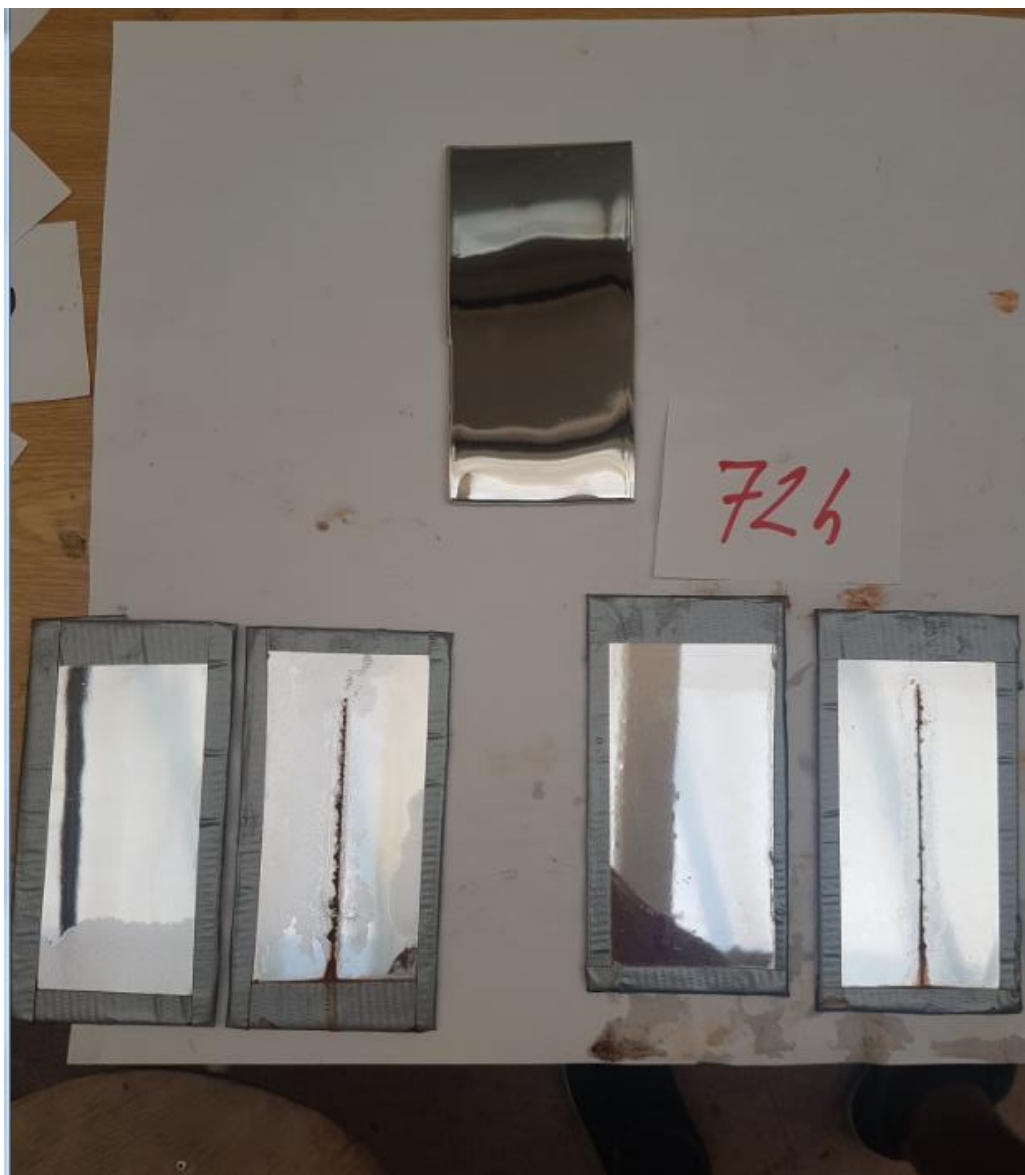
Obrázek 14 - Vzorok po 72 hodinách, počínající oxidace v porovnání se vzorkem s 0 hodinami v solné komoře.
