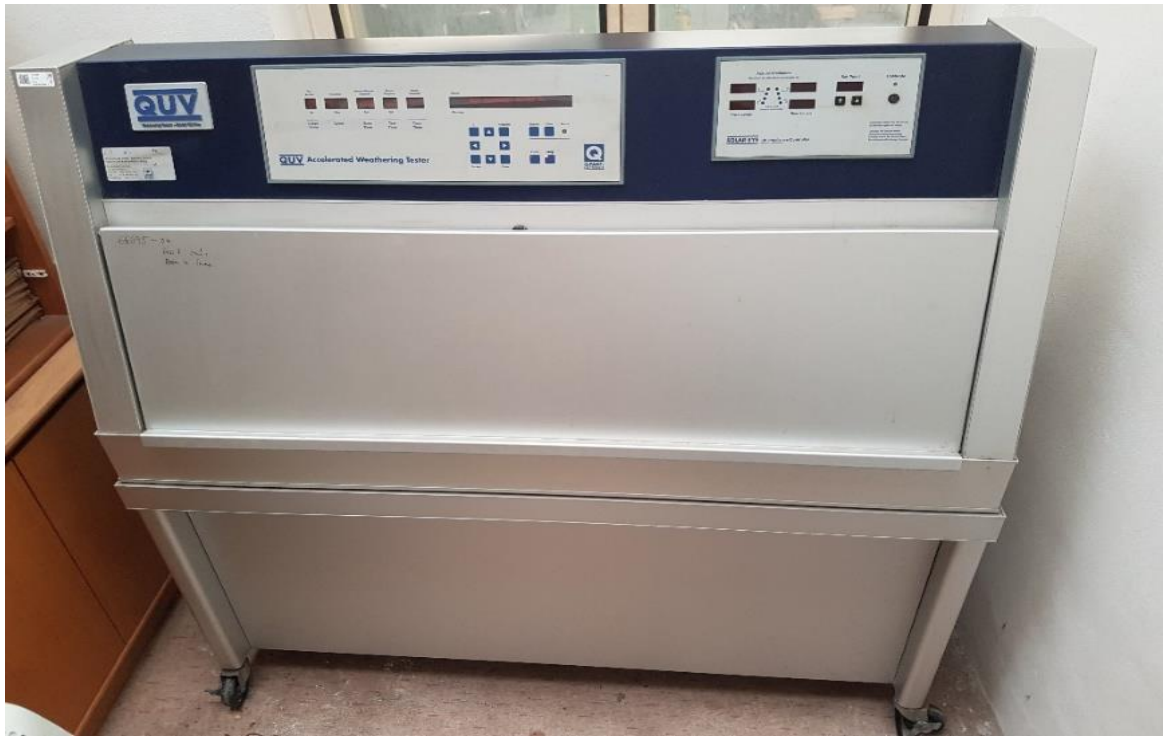
Obrázek 16 – Zařízení QUV/SE od společnosti Q-PANEL LAB PRODUCTS
