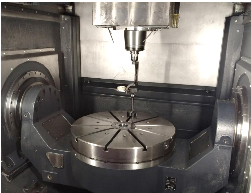
Obrázek 7-8 - Konfigurace pro měření kinematiky
