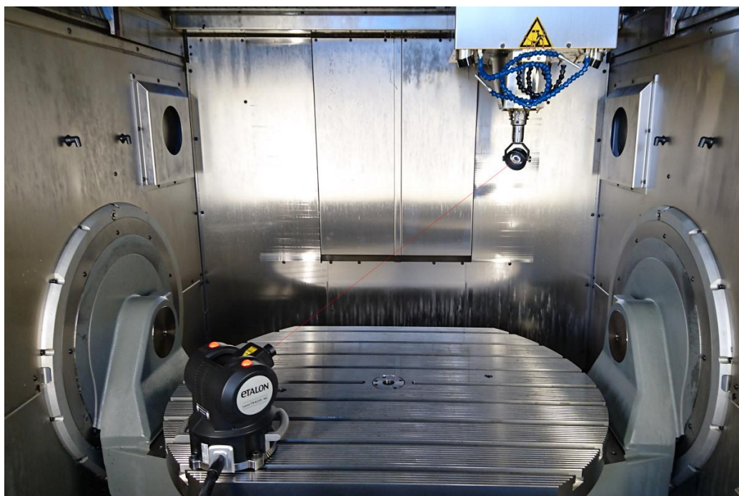
Obrázek 5-7 - Konfigurace při měření Lasertracerem [17]
