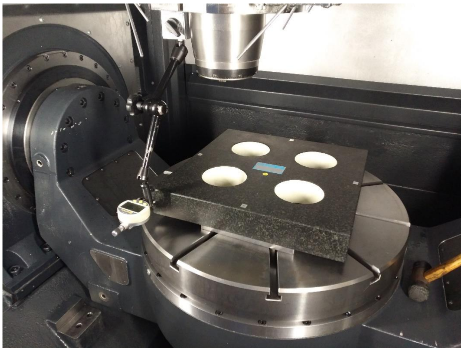
Obrázek 7-6 - Uspořádání pro měření kolmosti os X a Y
