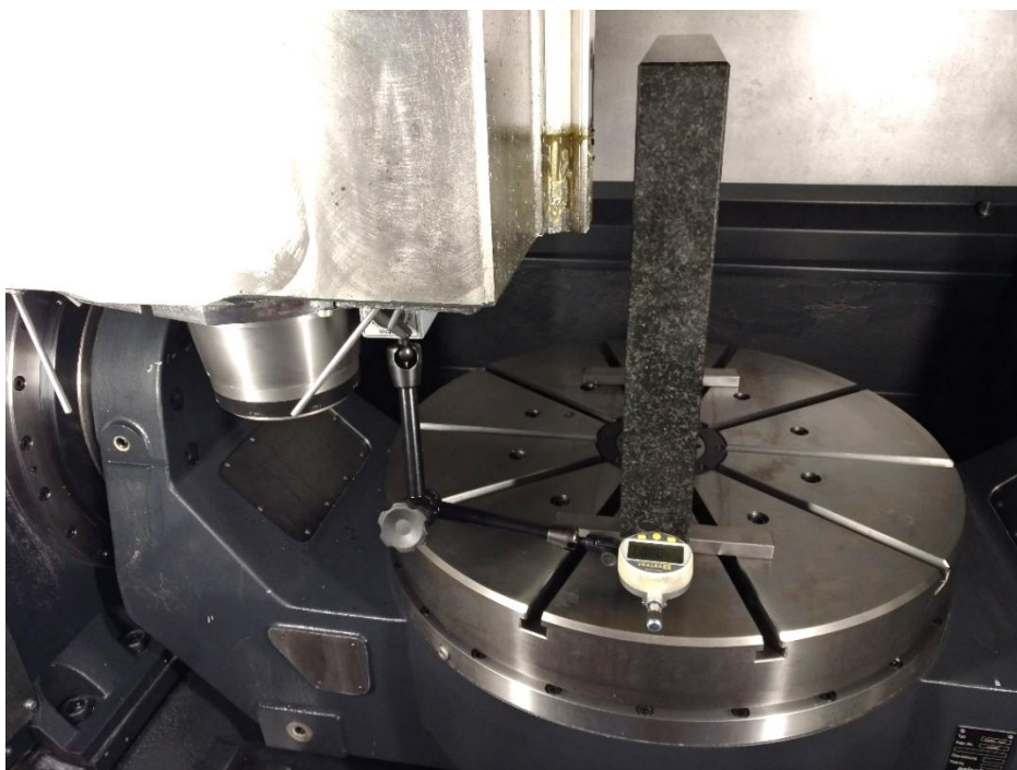
Obrázek 7-5 - Uspořádání pro měření přímosti osy Z v rovině YZ
