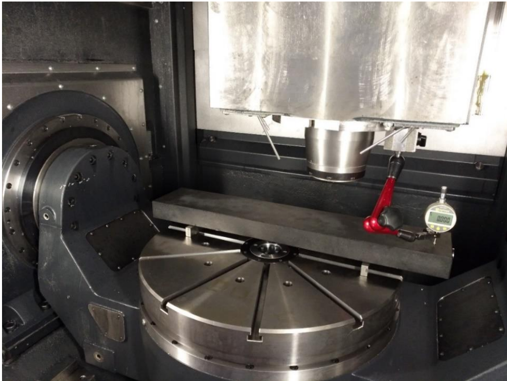
Obrázek 7-1 - Uspořádání pro měření přímosti osy X v rovině ZX
