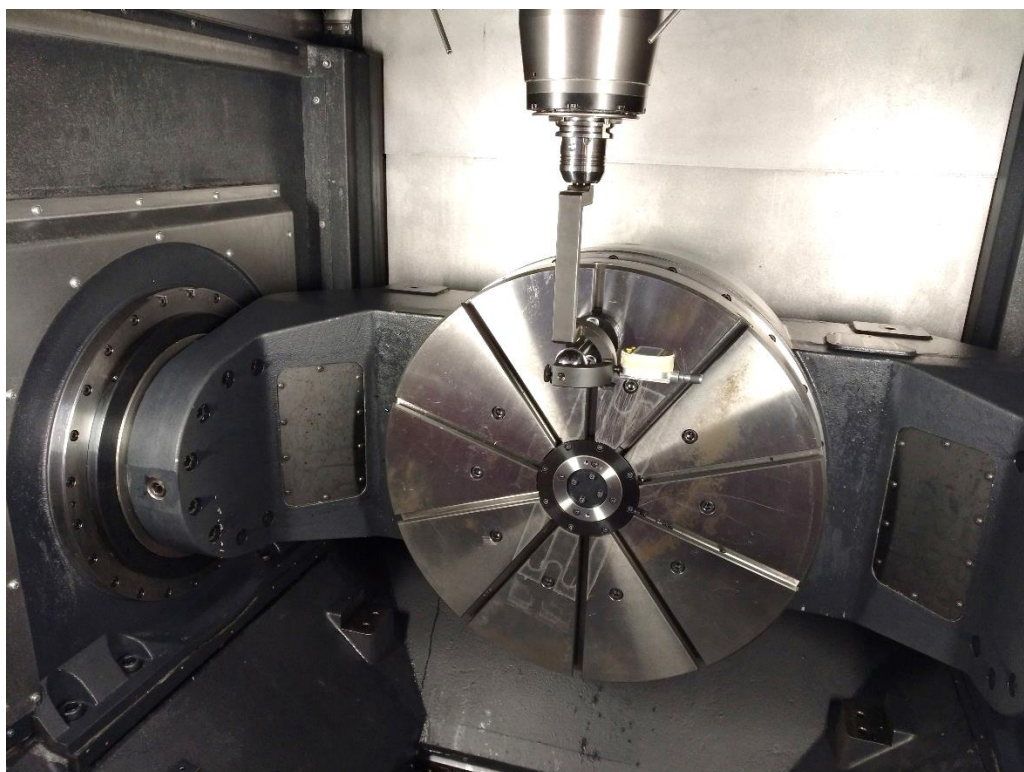
Obrázek 7-9 - Měření interpolace během polohování v ose A
