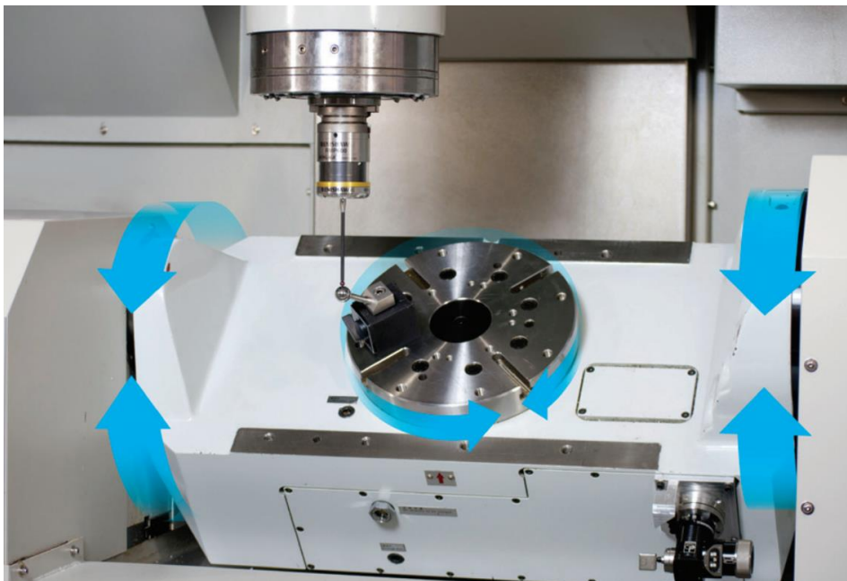
Obrázek 5-11 - Měření pomocí aparatury AxiSet od firmy Renishaw [23]
