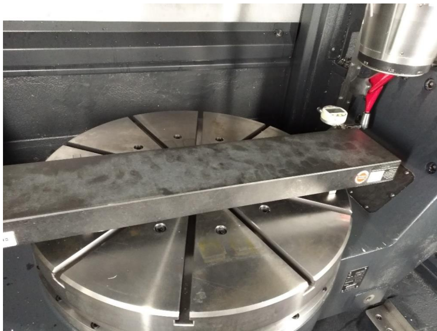
Obrázek 7-3 – Uspořádání pro měření přímosti osy X v rovině XY
