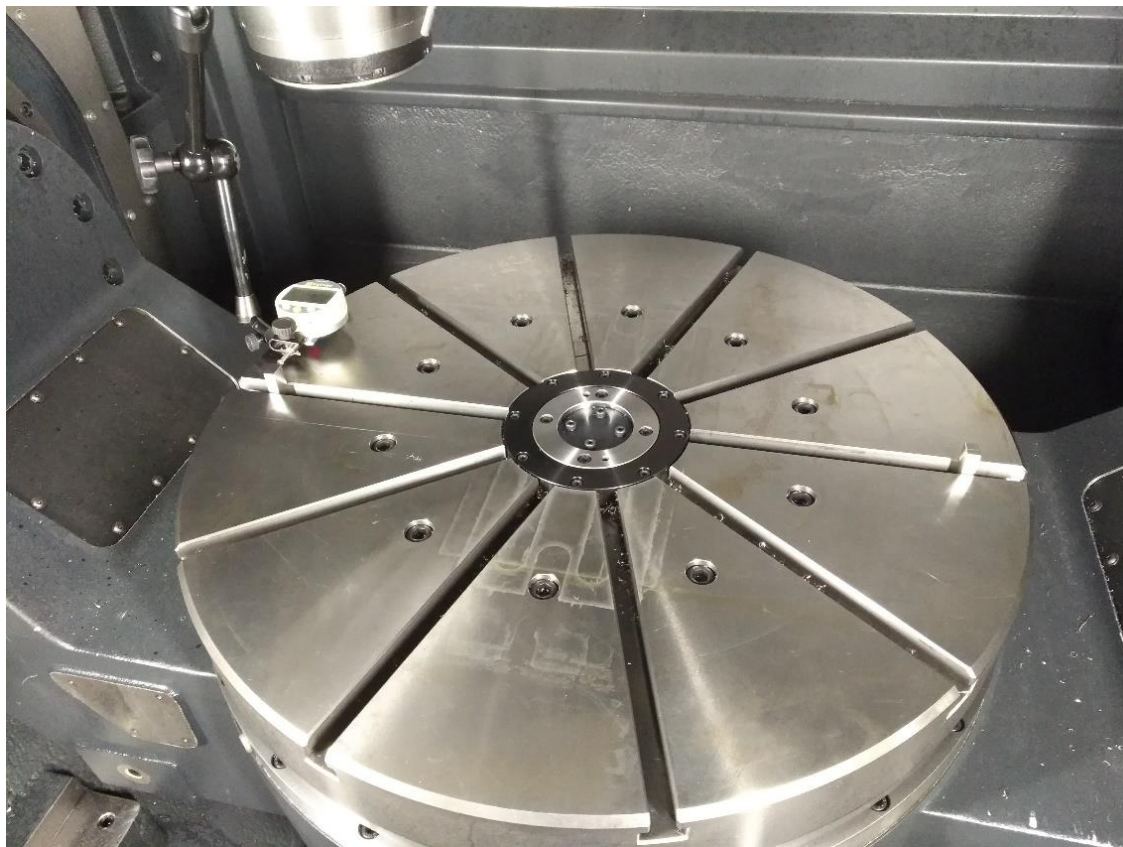
Obrázek 7-10 - Uspořádání pro měření chyby osy A
