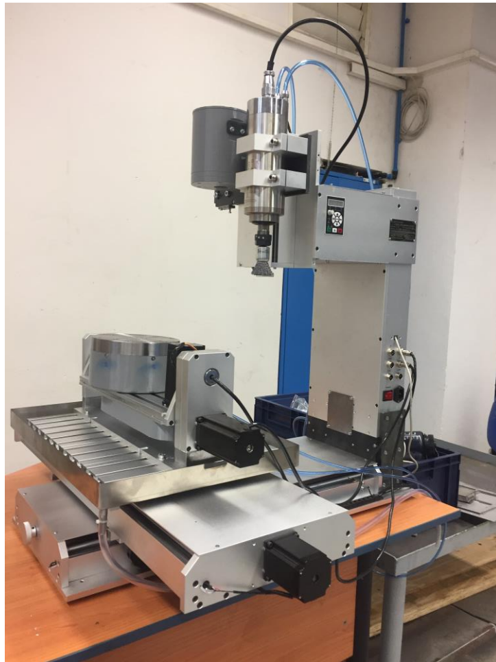
Obr. 118: Adaptovaná konstrukce 5ti osé gravírovací frézky
