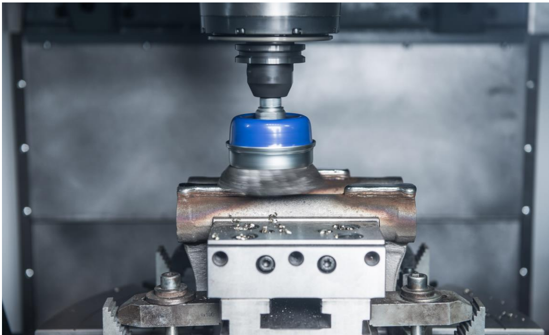
Obr. 24: Čištění dílce drátěným kartáčem [19]
