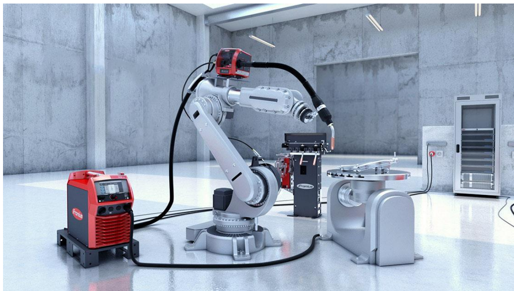
Obr. 14: Příklad automatického pracoviště technologie MIG/MAG od firmy Fronius [13]
