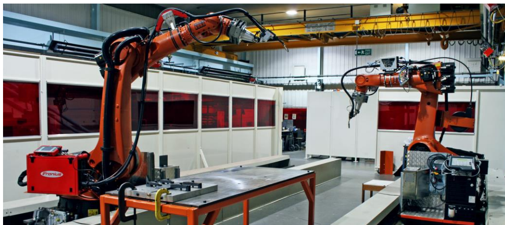
Obr. 5: Pracoviště s metodou WAAM Cranfieldské University [3]
