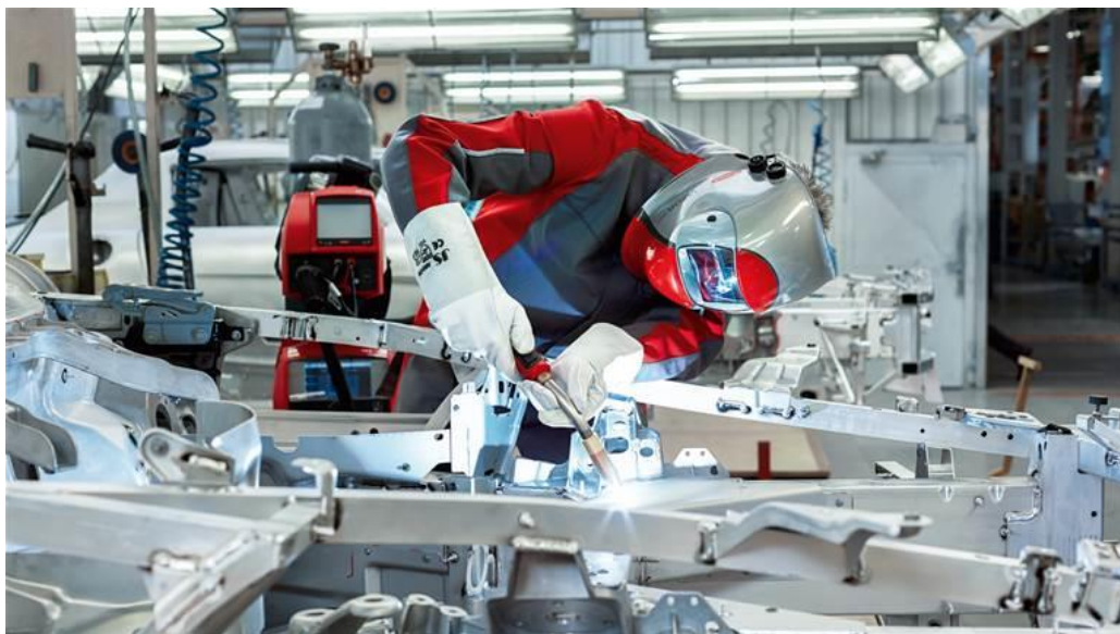
Obr. 12: Příklad poloautomatického svařování technologií MIG/ MAG od firmy Fronius [11]
