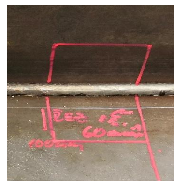
Obr. 24 Červená čára označuje místo řezu, kde se následně provede makrovýbrus pro vzorek č. 3
