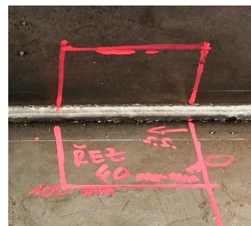
Obr. 22 Červená čára označuje místo řezu, kde se následně provede makrovýbrus pro vzorek č. 1
