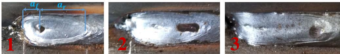
Obr. 33 Parametry délky svarové lázně, nastavené oblasti a_f , a_r
