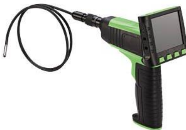
Obr. 11 Endoskop sloužící k nepřímé vizuální kontrole [i11]
