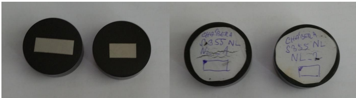
Obr. 25 Zkušební vzorky a jejich označení po vyjmutí z lisu
