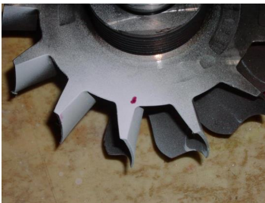
Obr. 12 Vada zvýrazněná metodou barevné indikace [i12]
