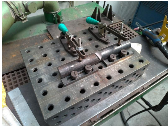
Obr. 46 Upnutí vzorků do přípravku před provedením svaru
