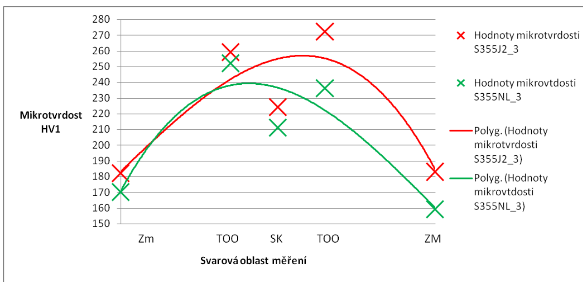
Obr. 57 Grafické znázornění rozložení hodnot mikrotvrdości – pro kořenovou oblast spoje
