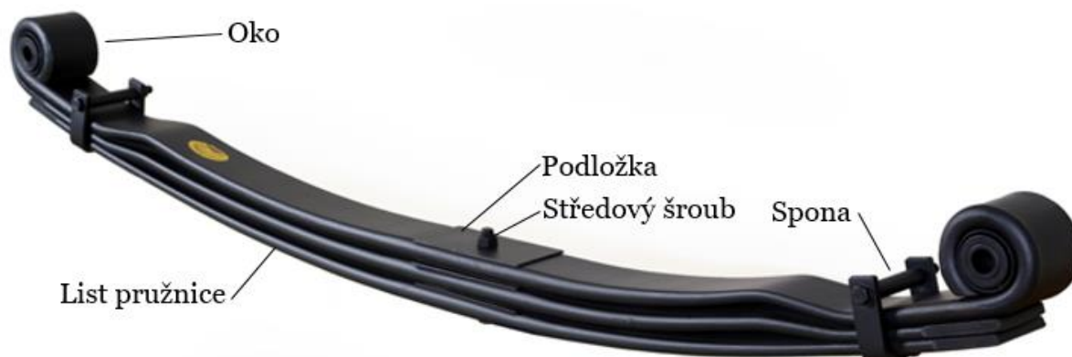
Obr. 22 – Parabolická pružnice [15]
