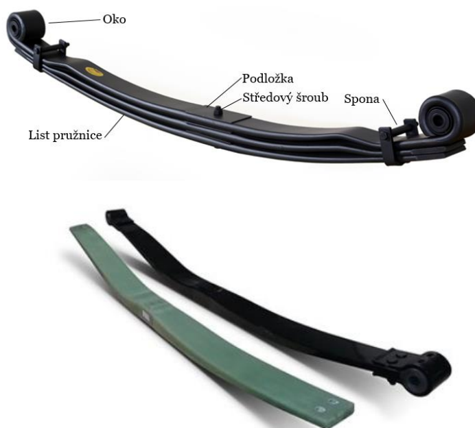
Ocelová parabolická pružnice (nahore), kompozitní listová pružnice (dole)
