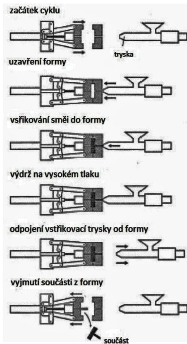
Obrázek 13: Proces vstřikování [9]
