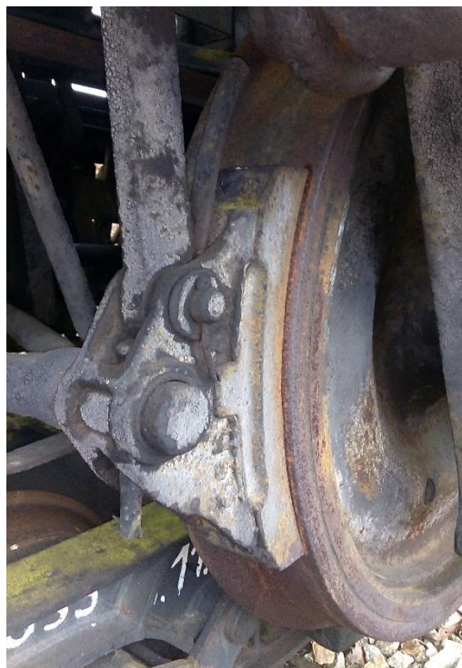
Obr. 14 - Detail uchycení dělené jednošpalíkové litinové zdrže a uchycení botky. (vůz je umístěn na úzkorozchodném podvalníku)
