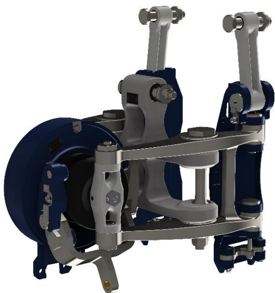
Obr. 34– Model brzdové jednotky kotoučové brzdy DAKO KBZ 10 RS 170 [13]
