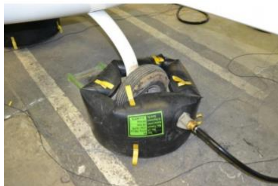
Obrázek 3 - Pneumatické uvolnění při PFZ [5]
