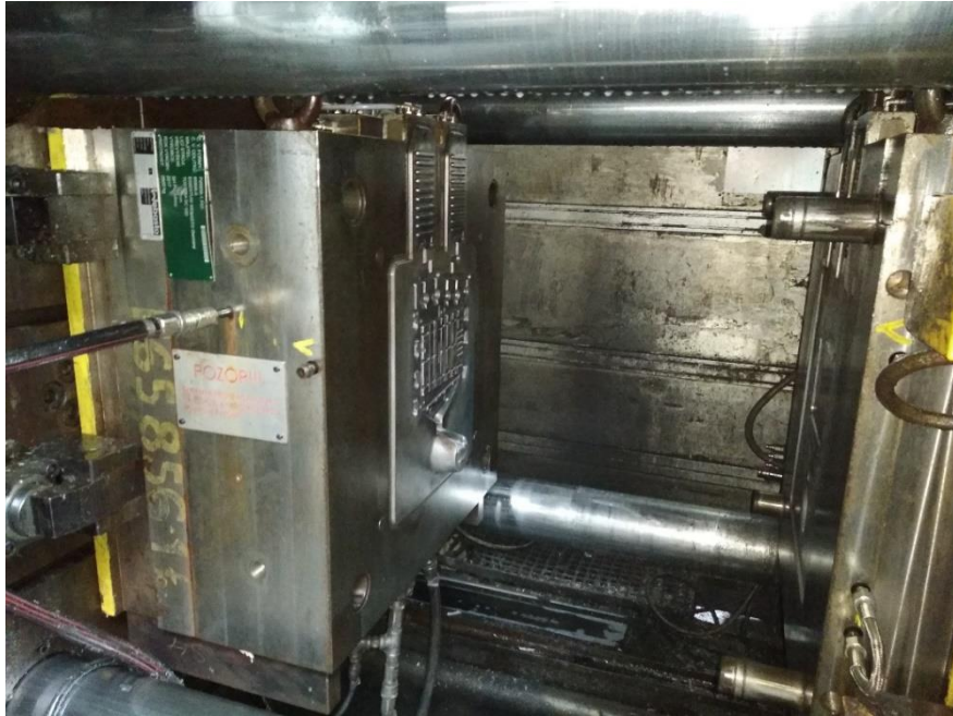
Obrázek 28: Pohyblivá polovina formy uvnitř lícího stroje připravená k výrobě
