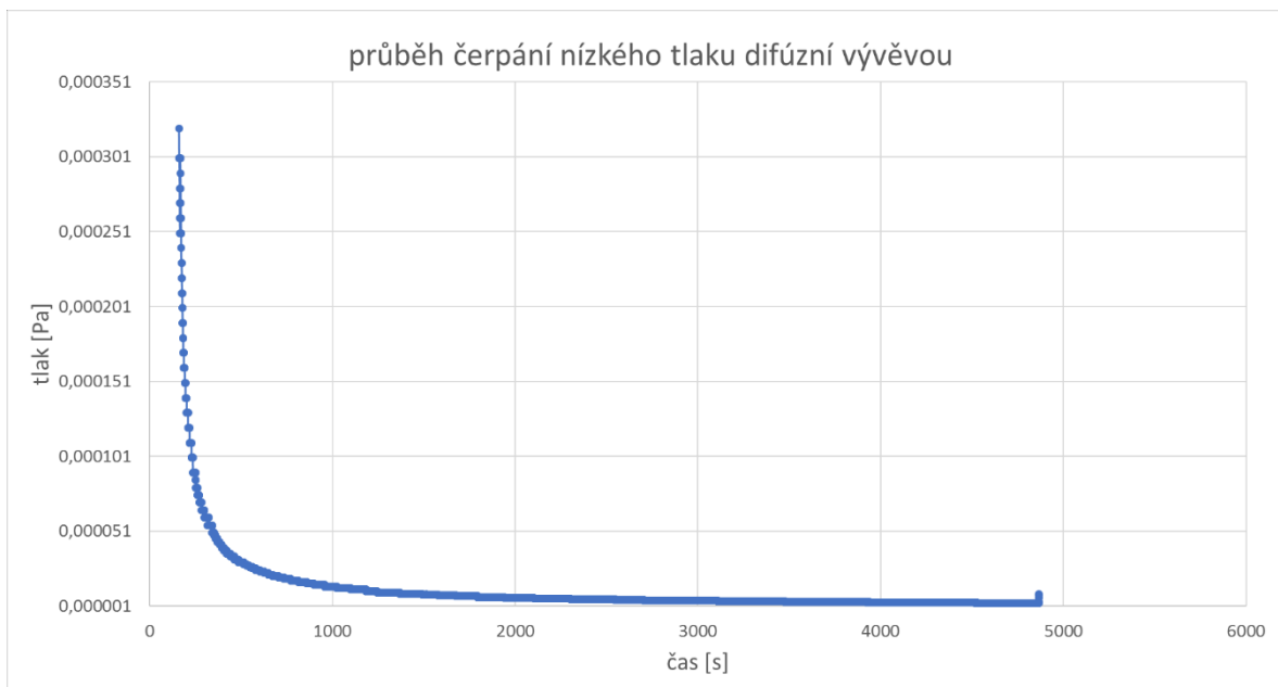
Obr. 54: Graf průběhu čerpání difúzní vývěvou do oblasti nízkých tlaků
