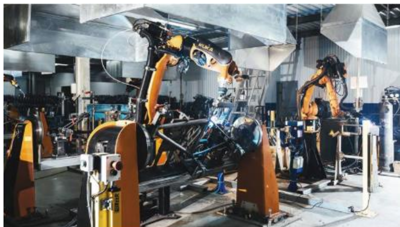
Obrázek 34 - Robotizované pracoviště pro svařování rámců jízdních kol [53]
