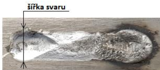
Obrázek 55 - Schéma měření ukončování svaru
