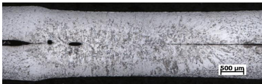
Obrázek 42 - nedostatečně spojený svarový spoj
