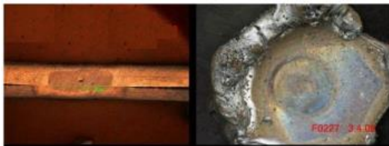
Obrázek 41 – pevné vměstky ve svarovém spoji [21]
