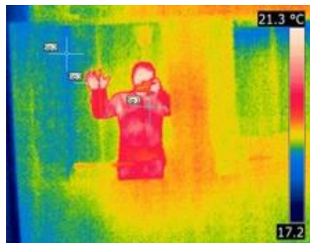
Obrázek 14 - vliv odražené zdánlivé teploty na naměřené hodnoty [15]
