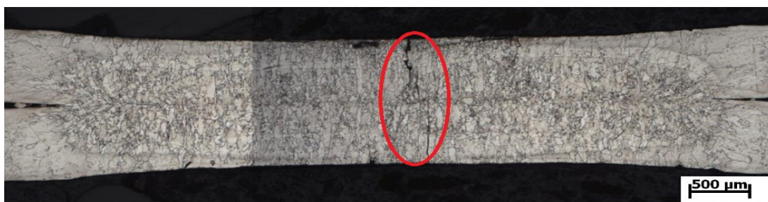
Obrázek 39 - mikrotrhlina ve svarovém spoji
