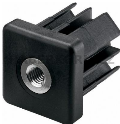
Obrázek 46 - Vložka se závitem M16 do profilu 60x60 mm [33]
