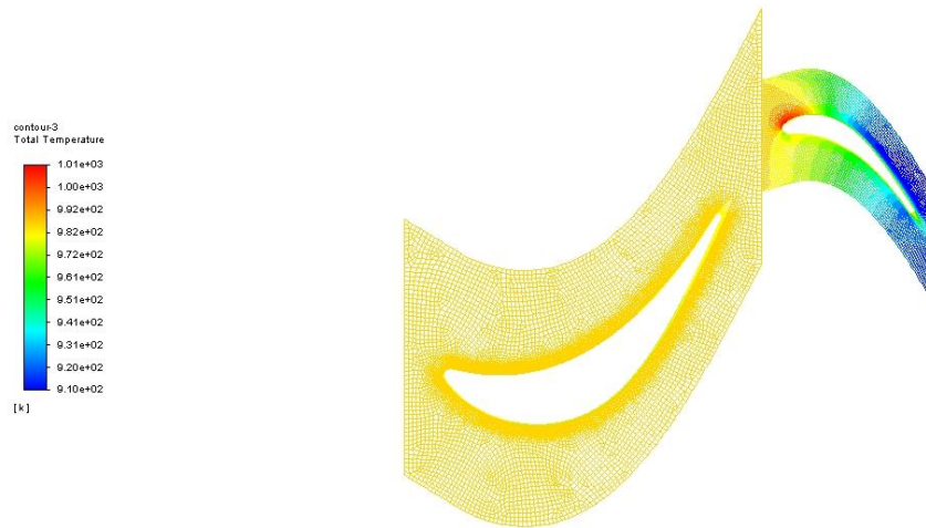
Obrázek 55: Skalární pole celkové teploty v proudovém poli 1. stupně volné turbíny
