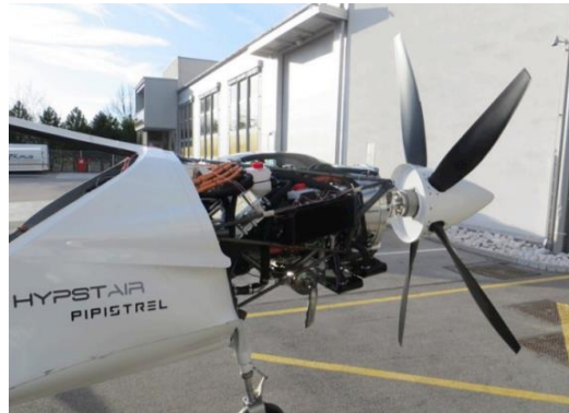
Obrázek 6 Hybridní pohon letounu HYPSTAIR (1)
