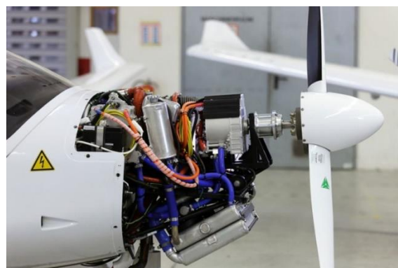
Obrázek 12 Pohonná jednotka letounu DA36 E (4)
