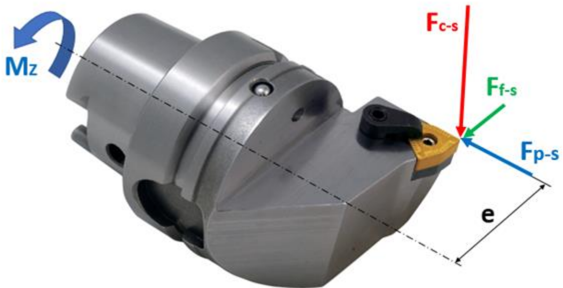
Obr. 25 - Schéma působení sil na soustružnický nůž
