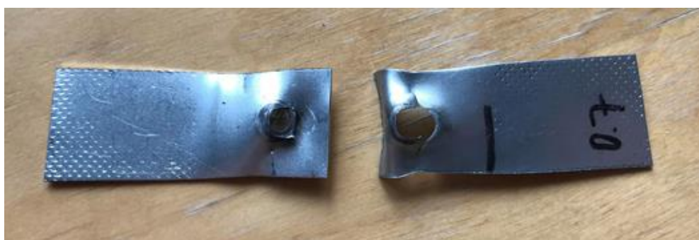
Obr. 31 Vzorek pro měření velikosti svarových čoček
