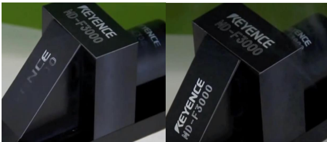
Obrázek 15: Rozdíl v označení 2D vs 3D řízeného laseru [27]
