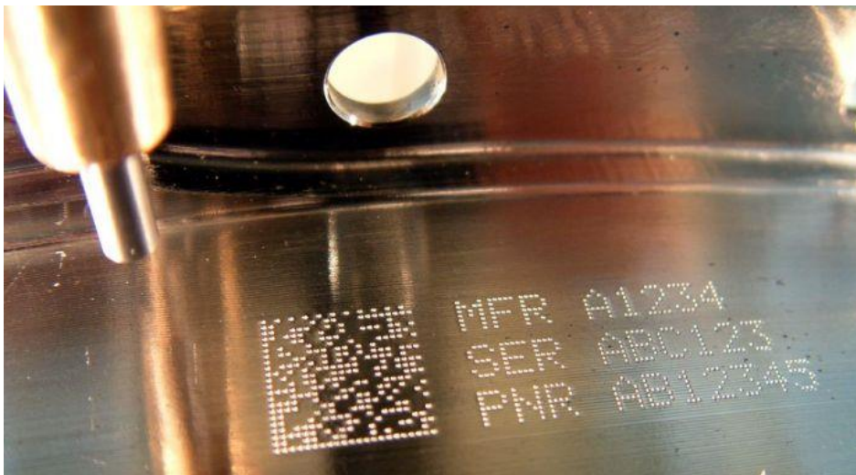
Obrázek 7: Označení ocelového dílu pomocí DataMatrix a textu [13]
