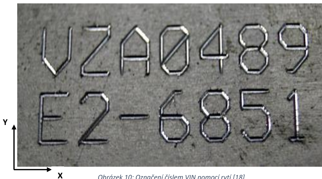
Obrázek 10: Označení číslem VIN pomocí rytí [18]
