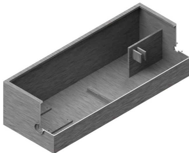
Obrázek 22. Skříň kolejového přestavníku
