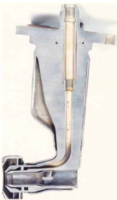
Obr. 3: Řez Air-blast palivovou tryškou. Zdroj: [2].
