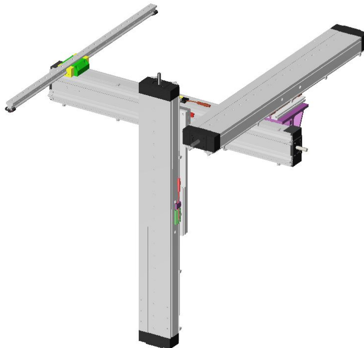
Obr. 26: Alternativní návrh traverzéry s osami od společnosti Bosh Rexroth.
