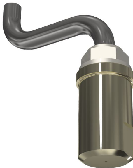
Obr. 17: Uvažovaná geometrie palivové trysky.
