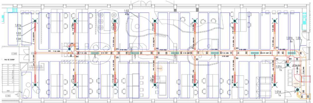
Obrázek 42.12 Umístění chladicích panelů v celém půdoryse
