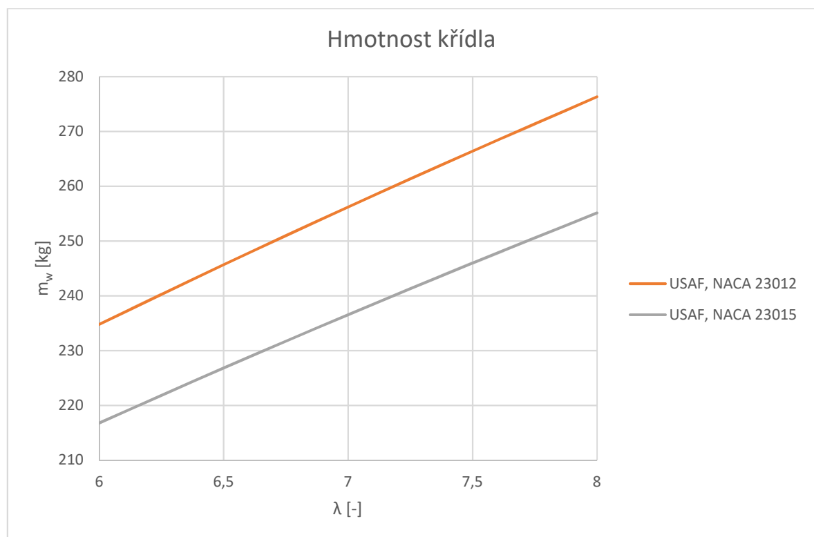
obr. 3.8 Odhad hmotnosti křídla pro různé profily v závislosti na jeho štiřlosti
