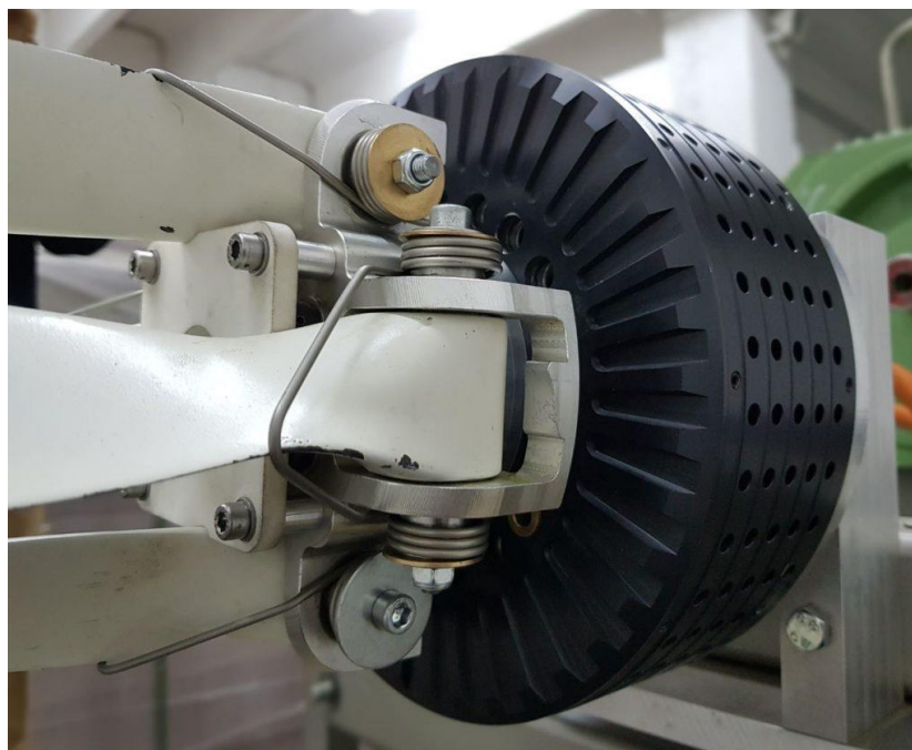
Obr. 4 Fixace listů pomocí torzních pružin [6]
