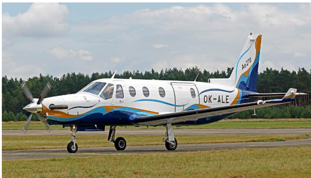
Obrázek 3 – Ae-270 prototyp č. 7 - podvozek s předovým kolem. [4]
