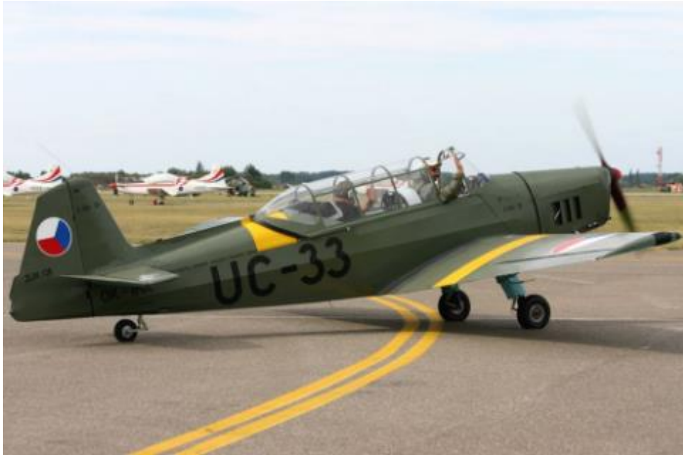
Obrázek 2 - Zlín Z 126 – podvozek s ostruhovým kolem.[4]
