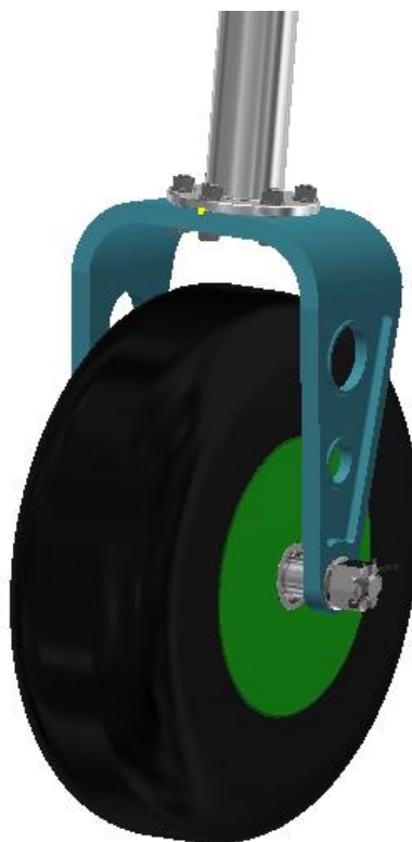
Obrázek 33 -Montáž kola do vidlice.
