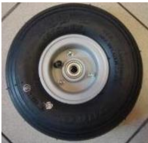
Obrázek 31 - Sestava příďového kola.
