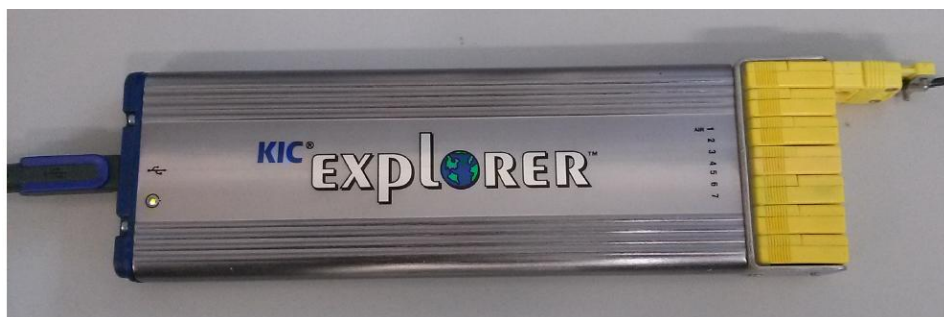
Obr. 38: Použité technologie při měření: (a) průběžná horkovzdušná pec MISTRAL 260 pro ohřev vzorků, (b) záznam teplotního profilu - profilometr typu KIC ON BOARD – Explorer a softwaru KIC 2000, vision 2.6.0.0.
