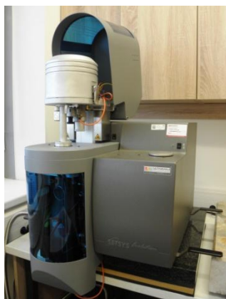
Obr. 69: Použitá měřicí aparatura pro analýzu DSC.
