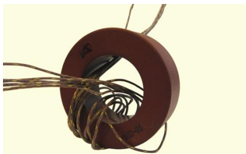
Obr. 50: Toroidní jádro tlumivky z amorfního kovu použité pro snížení vlivu rušení.
