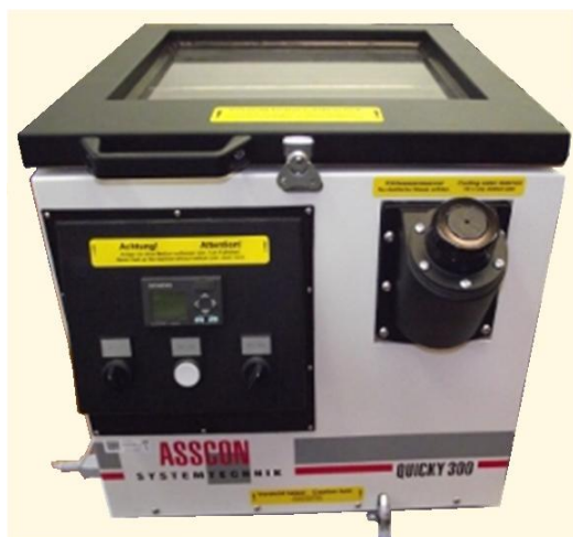
(a) (b) Obr. 34: Technologie pájení v parách: (a) příklad malého experimentálního zařízení, (b) schematické znázornění principu pájení v parách. [51]
