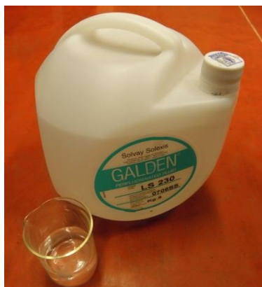
Obr. 35: Pracovní kapalina Galden (PFPE - perfluorpolyether).
