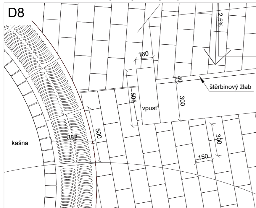
DETAIL DLAŽBY U OCELOVÉHO PÁSU, VPUSTI A ŠTĚRBINOVÉHO ŽLABU 1:20
