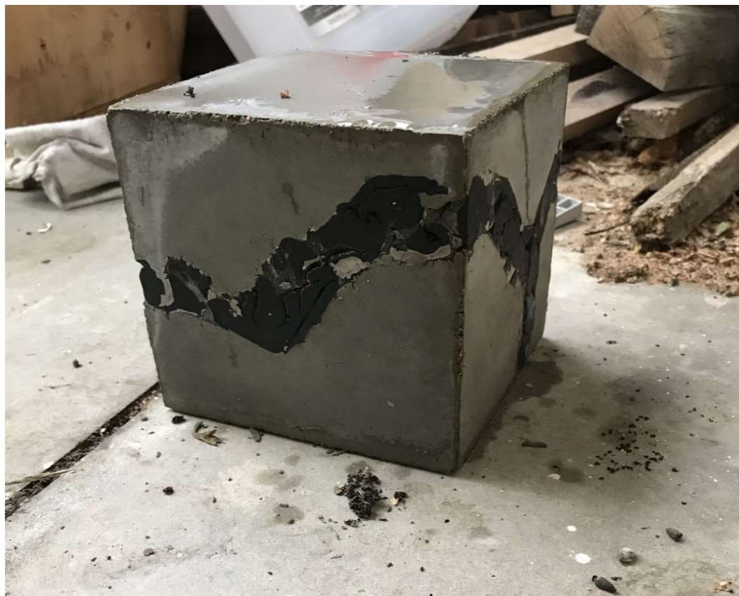
Krychle jsem po vyjmutí z formy pro jistotu ještě kropila, aby hrany dobře vytvrdly a nedrolily se.
