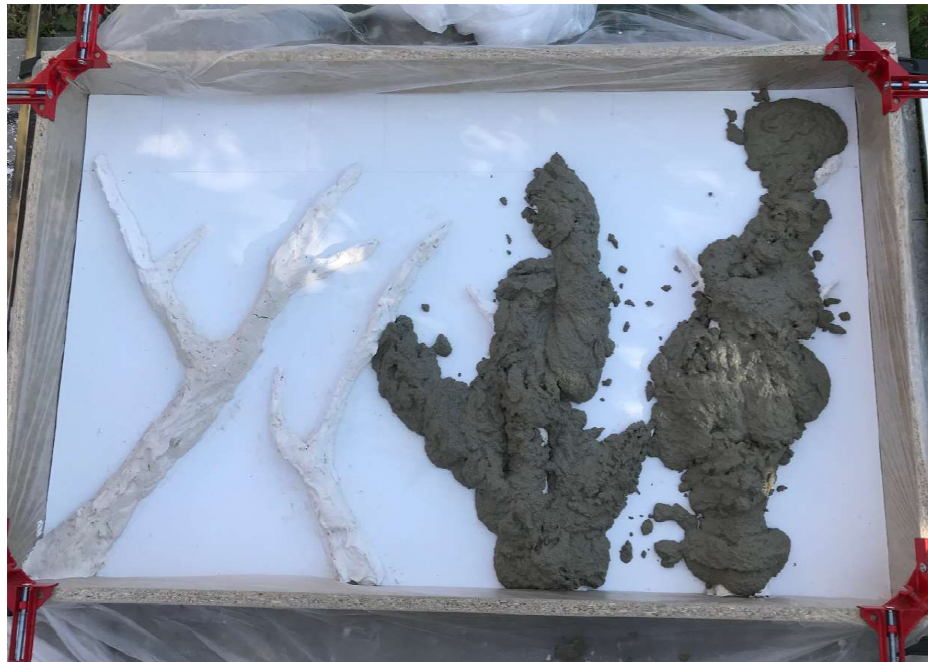
Sádrové spáry v pozitivu zalité čistým betonem, aby neprůsvítal keramzit
