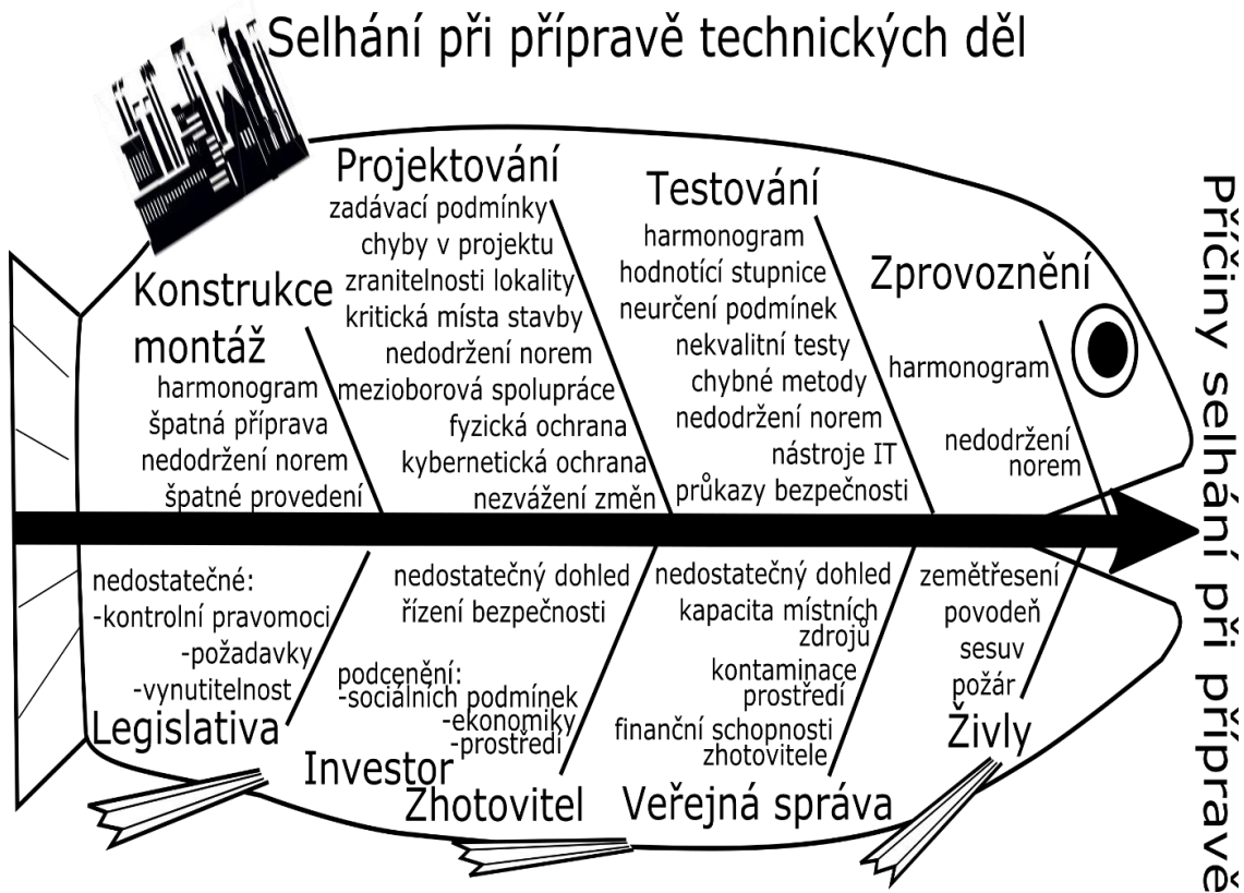
Obr. 32. Příčiny selhání koexistence technického díla a jeho okolí z důvodu nedostatků či chyb při projektování, zhotovení a spouštění technického díla do provozu.
