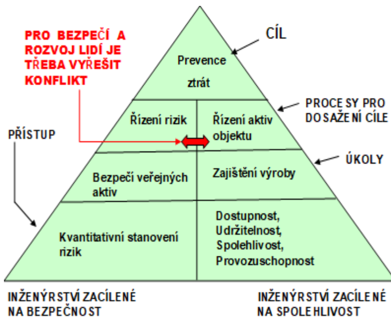
Obr. 2. Příklad základního konfliktu při řízení kritických objektů – sestaveno s uvážením představy v [56].
