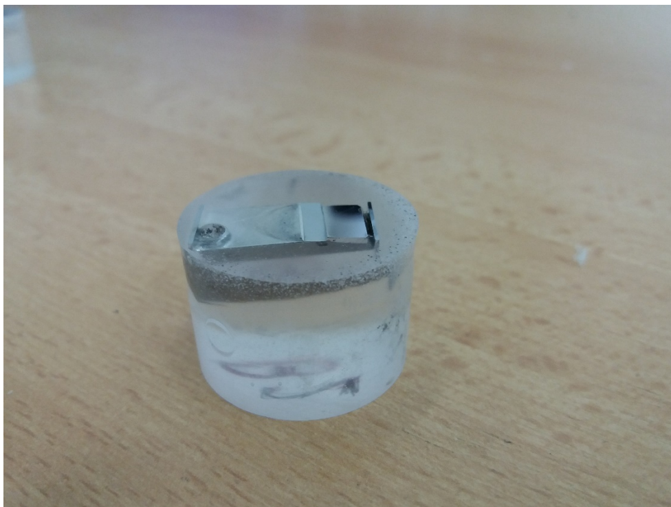
Obr. 50 – Hotový metalografický výbrus v hmotě CLAROCIT
