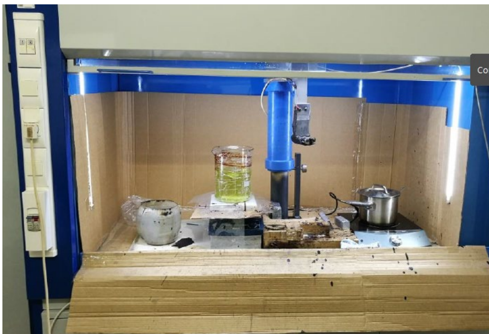
Obr. 60 – Zařízení pro odleptávání vrstev v laboratořích FS ČVUT
