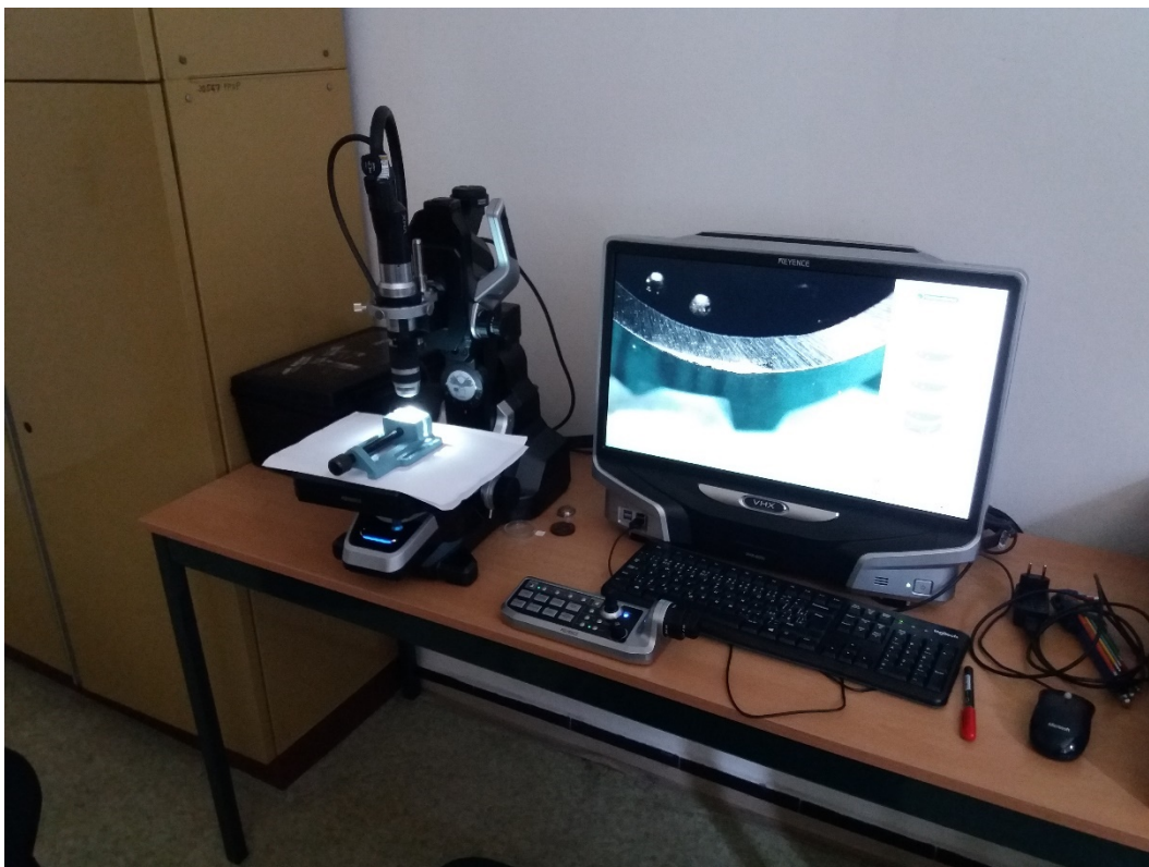
Obr. 40 – Pracoviště digitálního mikroskopu KEYENCE VHX 6000
