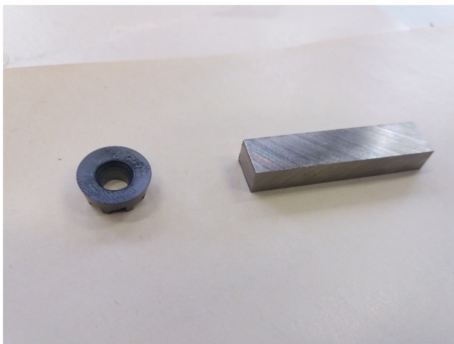
Obr. 48 – Nařezané vzorky na metalografické výbrusy v porovnání s břitovou destičkou
