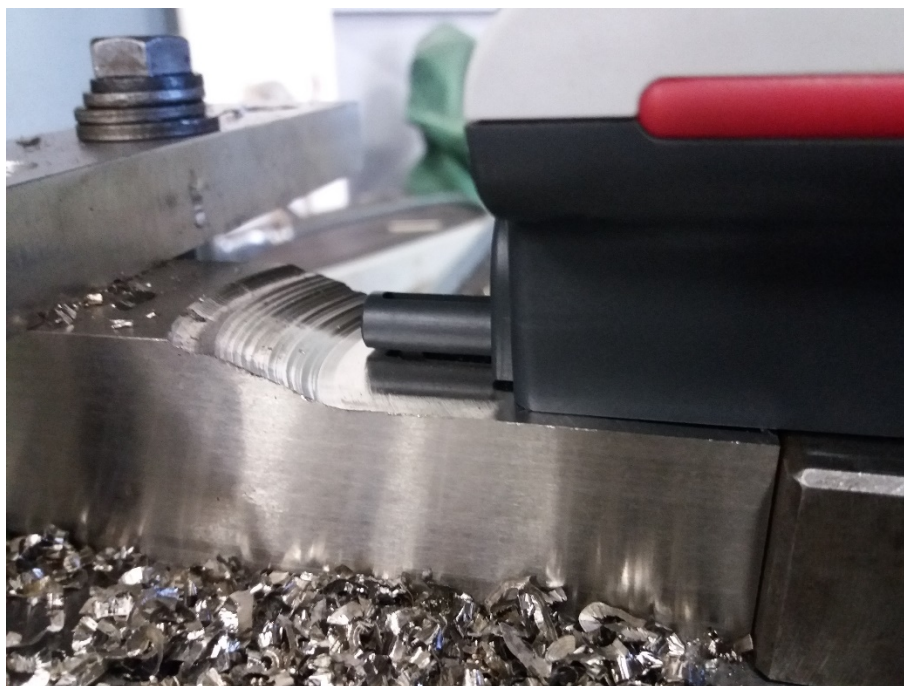
Obr. 38 – Měření drsnosti na obrobeném povrchu
