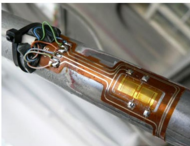
Obr. 16 – Tenzometrické měření sil na mostové konstrukci [23]
