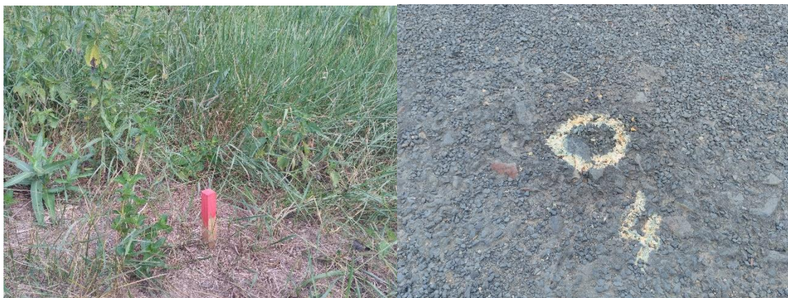
Obrázek 10 - příklady stabilizace bodového pole
