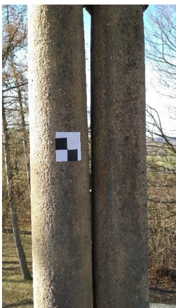
Obrázek 10 - Ukázka dočasné stabilizace vlicovacích bodů
