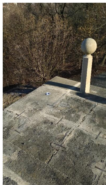
Obrázek 10 - Ukázka dočasné stabilizace vlicovacích bodů
