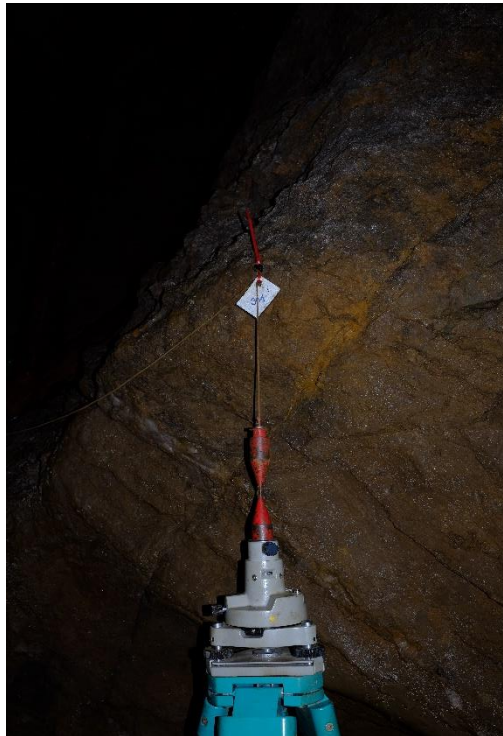
Obr. 9: Centrace TS [vlastní fotografie]
