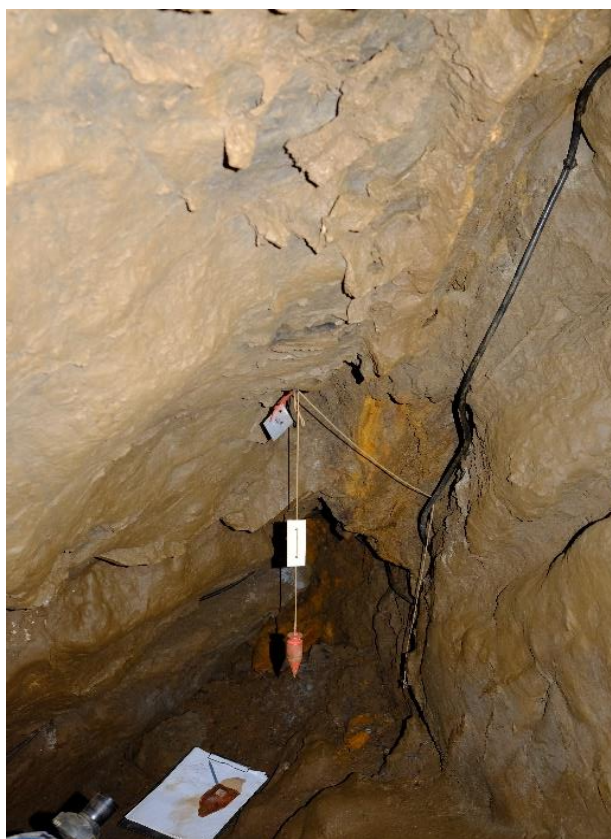
Obr. 10: Destička na olovnici pro bezhranolové cílení [vlastní fotografie]
