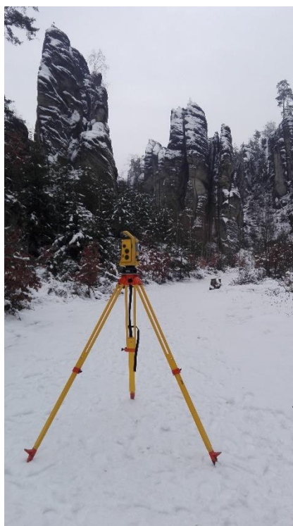
Obr. 7 Trimble S5 v terénu
