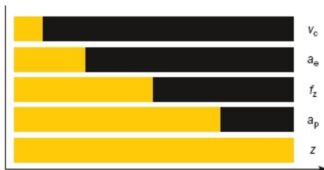
Obr. 15 Vliv řezných podmínek na životnost nástroje [9]
