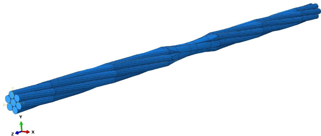
Obr. 27 3D model oslabení 2 mm
