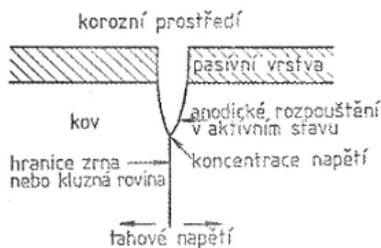
Obr. 17 Vznik korozního praskání [17]
