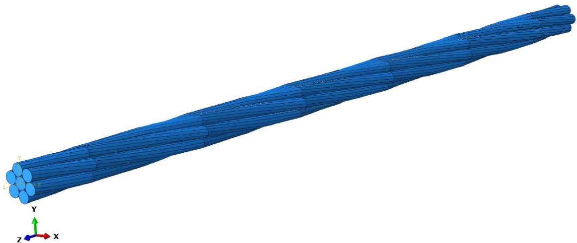
Obr. 23 3D model neoslabeného lana
