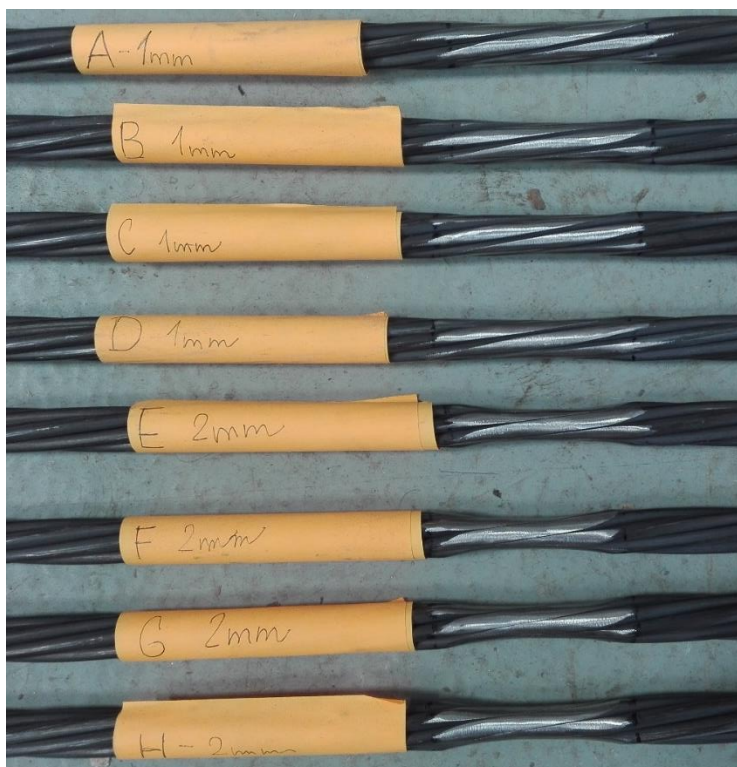
Obr. 54 Opracovaná předpínací výztuž (foto: Tomáš Dejmek)
