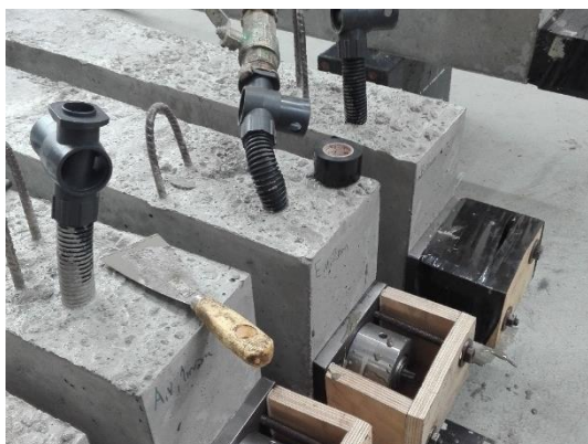
Obr. 60 Injektáž vybraných vzorků (foto: Tomáš Dejmek)
