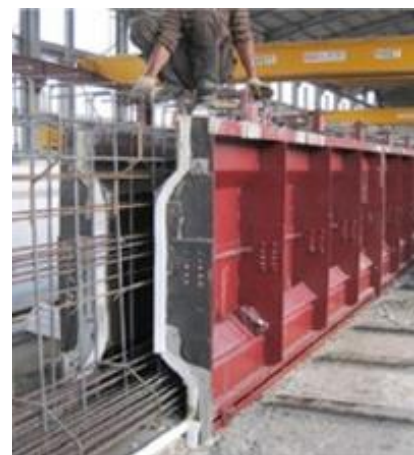
Obr. 5 Výroba předem předpjatého nosníku [24]
