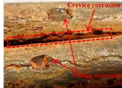
Obr. 16 Bodová a štěrbinová koroze [21]
