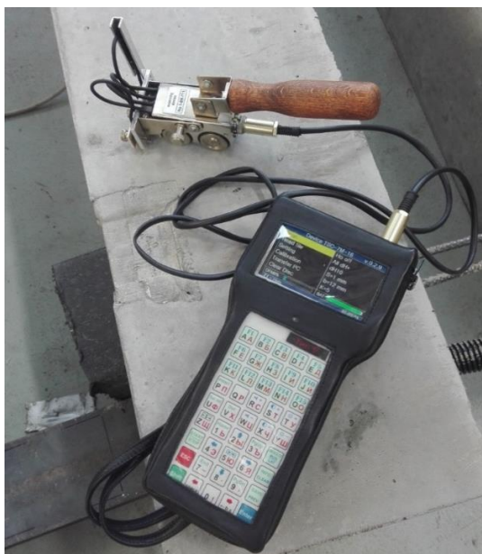
Obr. 64 Přijímací zařízení TSC-7M-16 (foto: Tomáš Dejmek)
