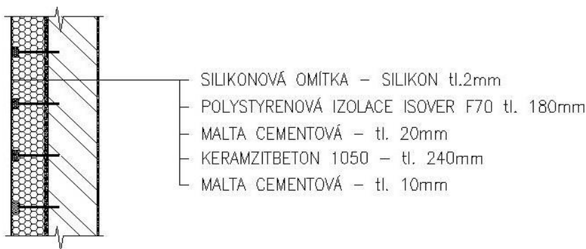
Obr. č. 16 Kontaktní zateplení průčelní stěny s EPS
