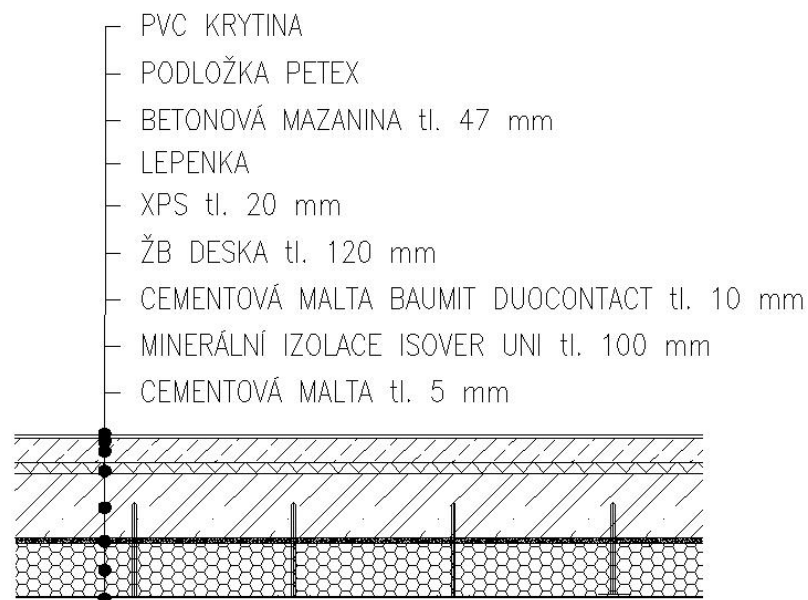
Obr. č. 22 Zateplení stropu s minerální vatou
