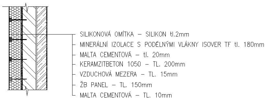
Obr. č. 17 Kontaktní zateplení štítové stěny s minerální vatou
