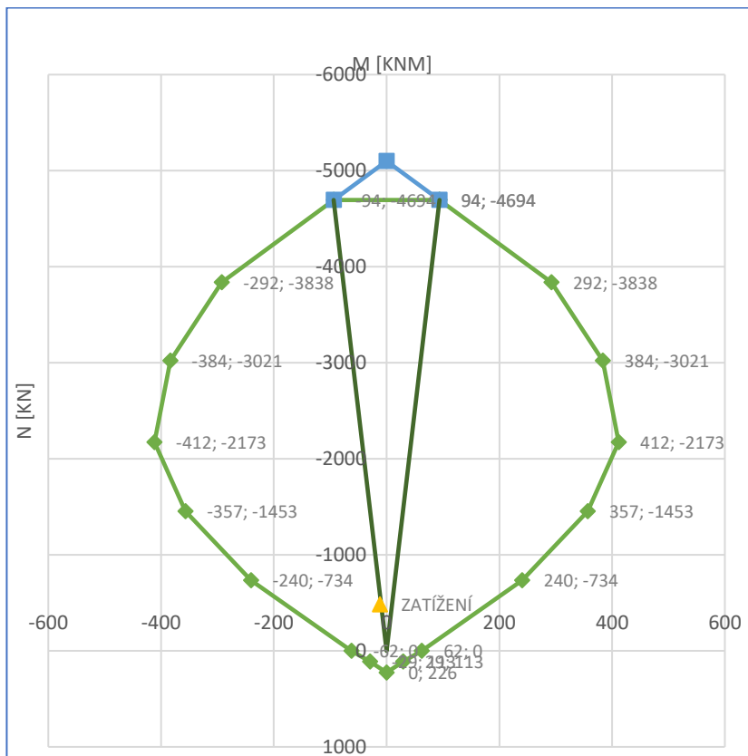
Obrázek 25 - IDP s účinky II. řádu při požáru; ruční výpočet v Excelu
