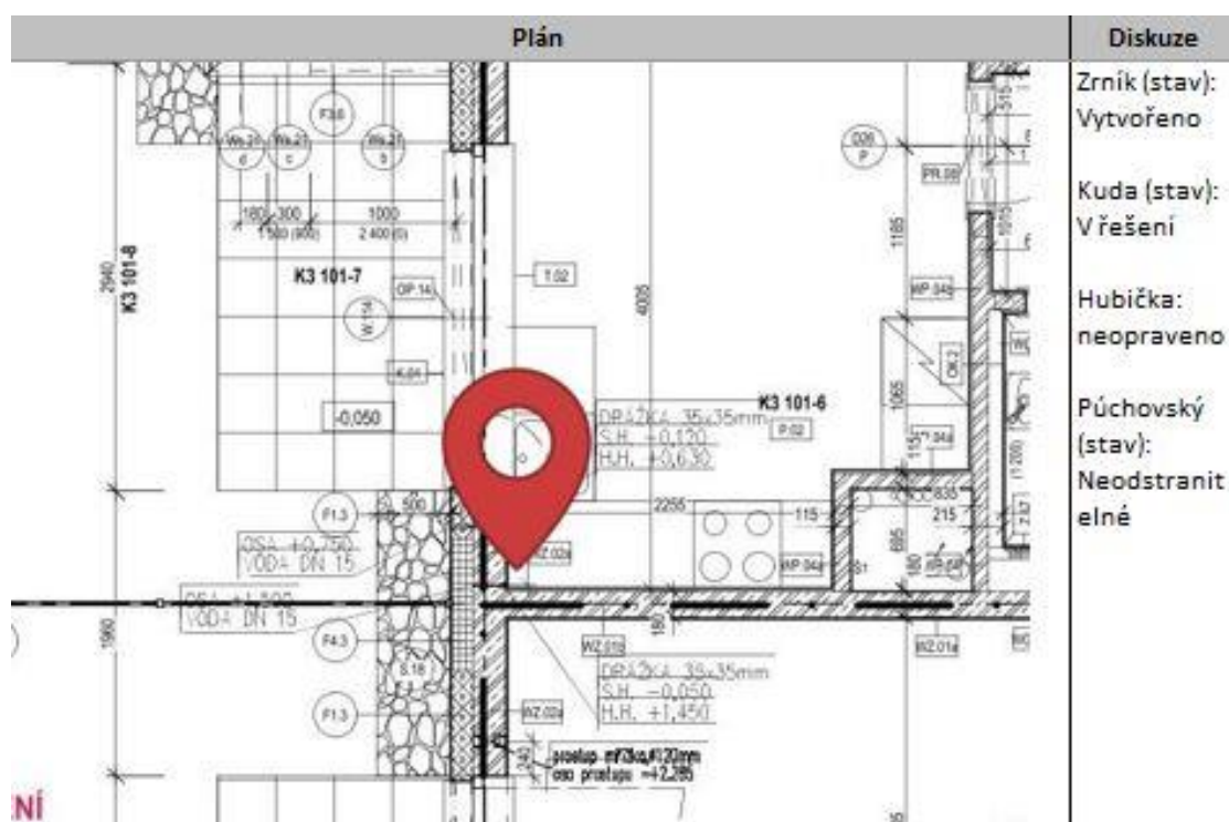
Obrázek 13 – Příklad vady, nedodržení pravoúhlosti. 3/3
