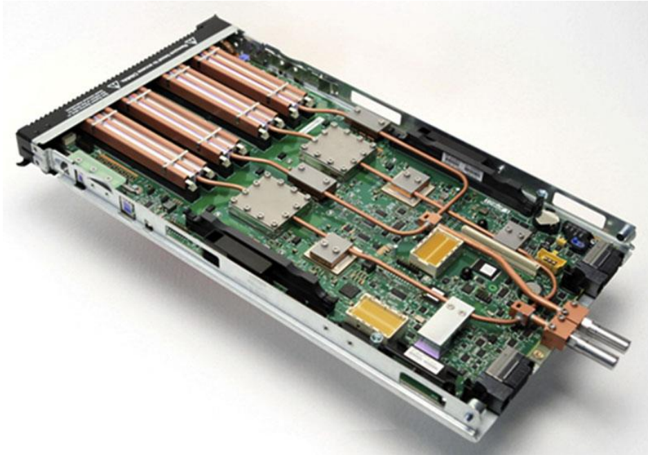
Obrázek 22: Vodní chlazení rack serveru –Aquasar [20].
