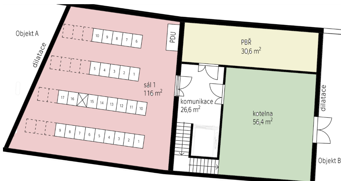
Obrázek 18: Půdorys spodního podlaží (3.PP) navrženého datového centra.
