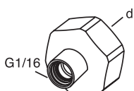
Přechodka pro napojení kapiláry
