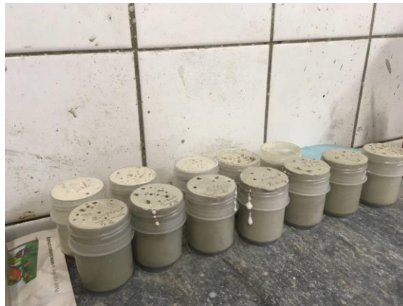
Obr. 4: Vzorky směsí testované na dobu tuhnutí a tvrdnutí
