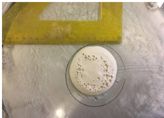
Obr. 6: Měření rozlité směsi
