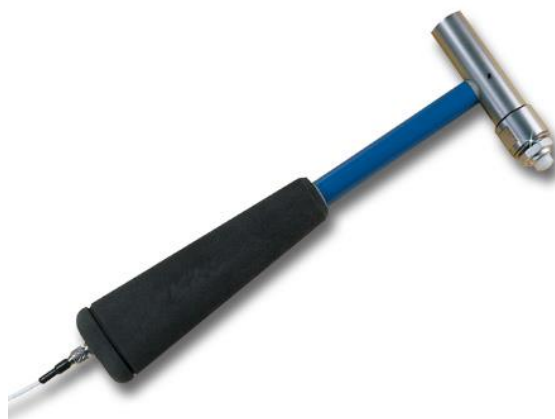
Obr. 13: Rázové kladívko. (zdroj: OMEGA Engineering inc., web: https://in.omega.com/pptst/IH101.html )
