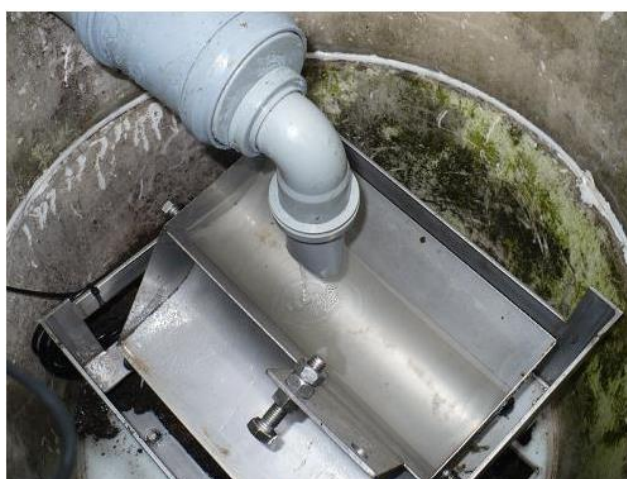
Obrázek 27 Překlápěcí člunkový průtokoměr PF500, Zdroj: Fiedler company, 30.3.2019
