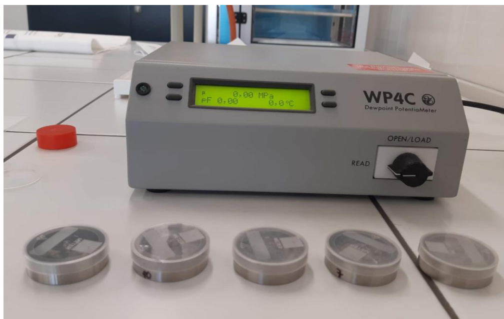
Obrázek 10 Průběh měření tlaku na přístroji WP4C, 18.4.2019
