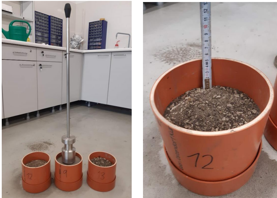
Obrázek 22 Vzorky při hutnění Proctorovým kladivem, 18.04.2019
