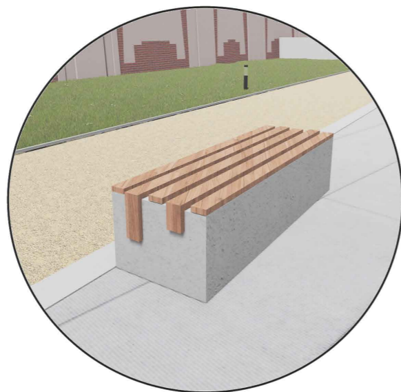
M1 LAVICE MALÁ materiál: beton, dřevo rozměry: 2500x800x750mm vlastní návrh
