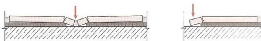
Obr. 5 Keramický prvek není podepřen v celé ploše lepicí hmotou bod a)
